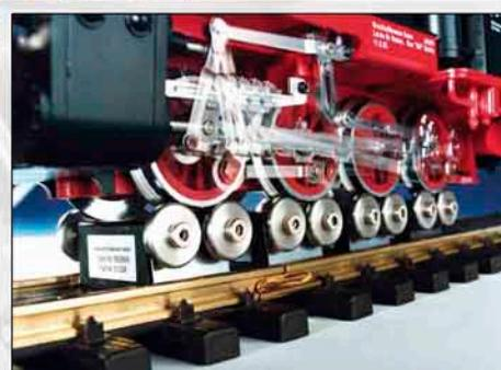
Im Set enthalten sind vier einzelne Rollböcke für je eine Achse. Des Weiteren ein Schleiferbock, der die Schleifer zur Stromabnahme einer Lok zusätzlich kontaktiert, sowie ein LGB Gleis (30cm) und eine Gleis-Einlegeplatte, auf denen die einzelnen Elemente des Rollprüfstands arrangiert werden. Als weiteres Zubehör erhältlich, ist eine Sound-Auslöseeinheit mit Elektromagnet zum Auslösen von Glocke, Pfeife oder Horn, sowie ein Erweiterungsset mit zwei Achslagerböcken.
